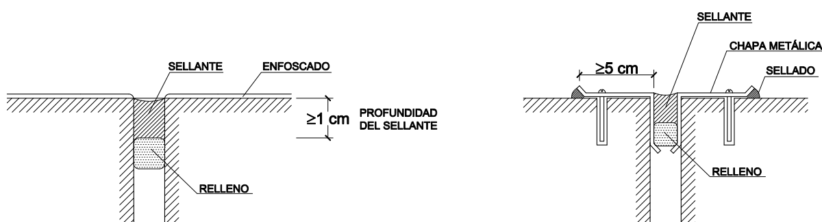
Figura 2.6 Ejemplos de juntas de dilatación
